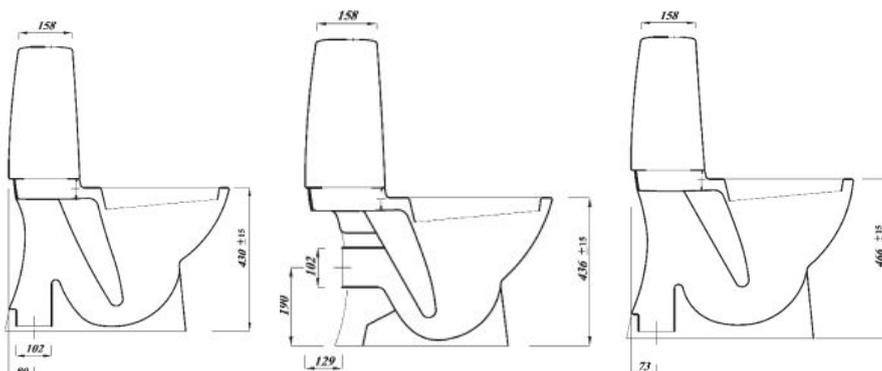
Alle modeller har helstøpt sisterne med forkrommet spyleknapp for dobbelspyling på 3 eller 6 liter. Det anbefales å tette foten på klosettet mot gulv med elastisk fuktbestandig masse som hindrer at vann trenger inn under foten. For montering av nrf 6130892 anbefales Tec 7 eller lignende. Montering med sement kan sprekke foten så dette anbefales ikke.
