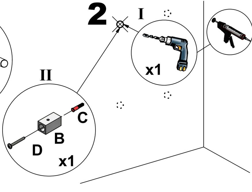
Skruvinfästningar i våtzon 1 ska göras i betong eller annan massiv konstruktion, träreglar, träkortlingar eller i konstruktion som är provad och godkänd för infästning, till exempel skivkonstruktion. Se exempel på godkända konstruktioner på säkervatten.se.
