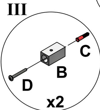
Skruvfästningar i våtzon 1 ska göras i betong eller annan massiv konstruktion, träreglar, träkortlingar eller i konstruktion som är provad och godkänd för infästning, till exempel skivkonstruktion. Se exempel på godkända konstruktioner på säkervatten.se.
